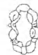
爪式保持架 Tongue-type cage
